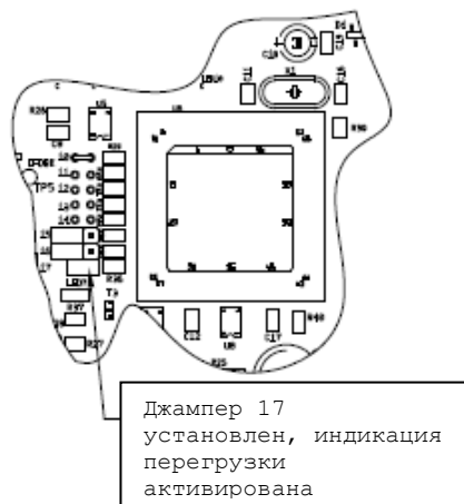
Рисунок 18: расположение джампера - Активация индикации перегрузки
